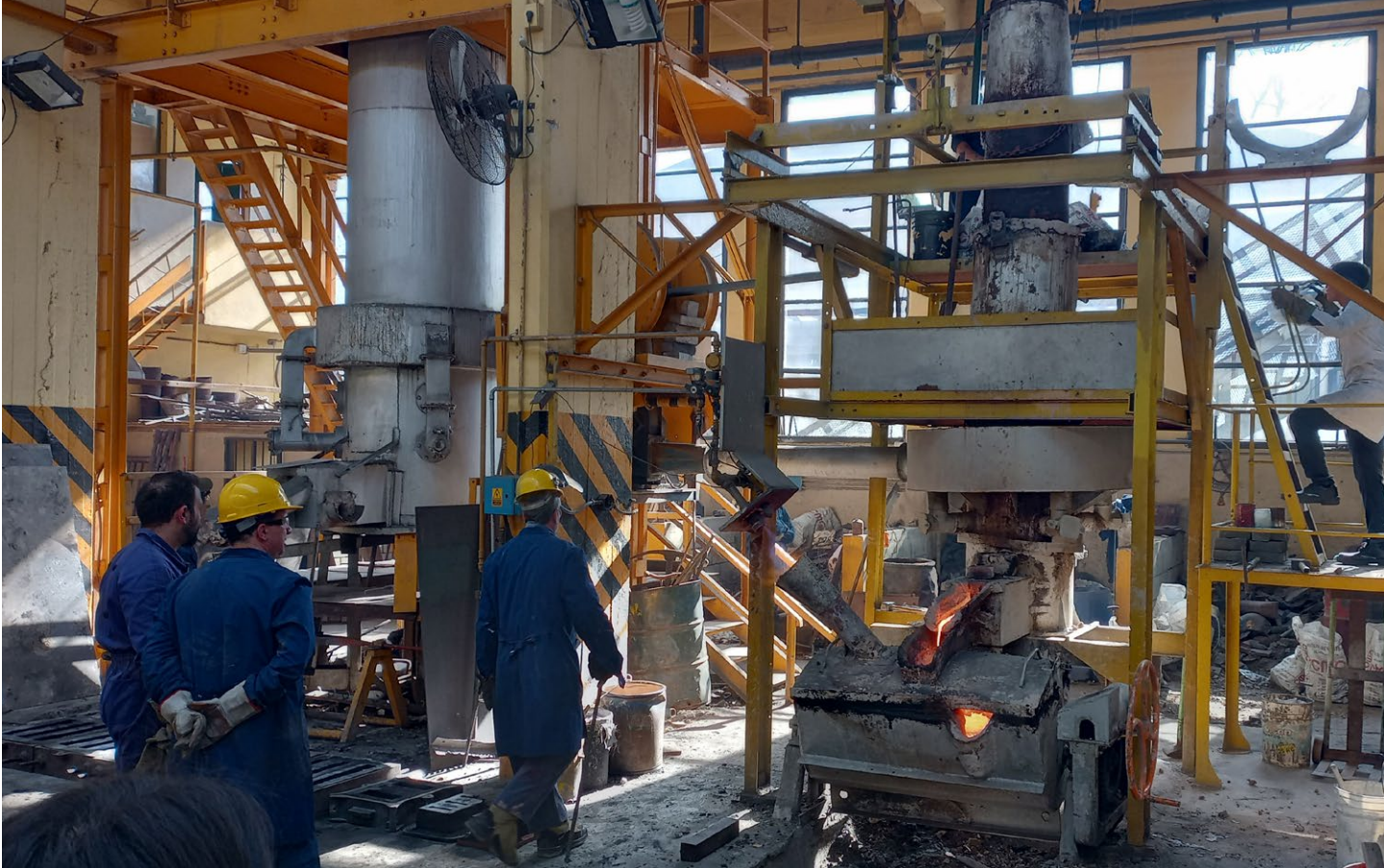
Prácticas de fundición en horno cubilote realizadas por alumnos.
