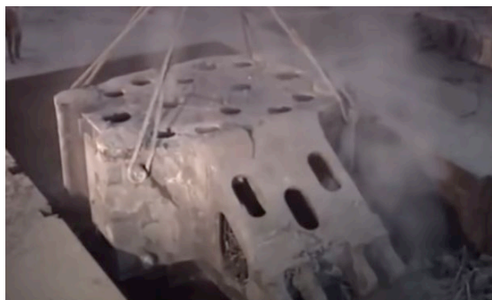
Soporte de martinete para forja de blindados de guerra, que se cuela durante 5 minutos y deja enfriar en el molde durante 7 semanas
