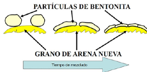
Evolución de la cobertura con bentonita de los granos de arena durante el mezclado
