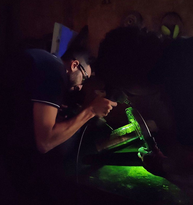
Ensayo de partículas magnetizables fluorescentes
