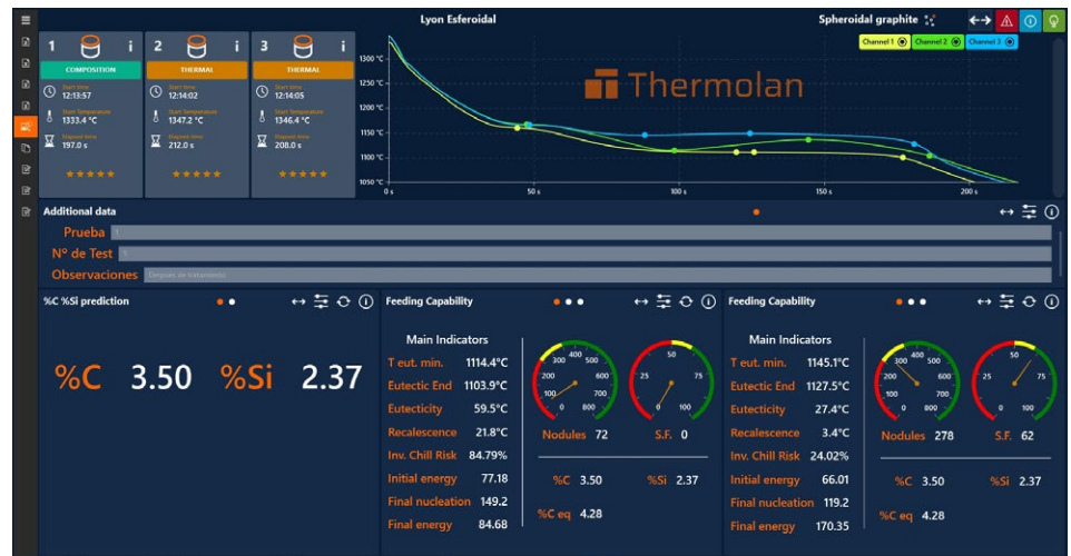
Figura 2. Pantalla principal de un analizador térmico (en este caso, Thermolan®), donde se muestran datos relevantes parametrizados con este análisis
