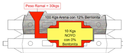
Esquema de molde con arena, noyo y ramal, utilizado para el cálculo de reposición de bentonita
