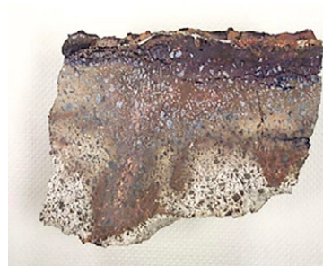
Figura 6 Ilustración de filtración metálica severa y subsiguiente saturación de metales localizada. Eventualmente esto conducirá a una severa condición de erosión
