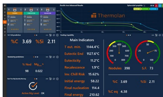
Figura 7. Pantalla de resultados para control de calidad metalúrgica (GJS)
