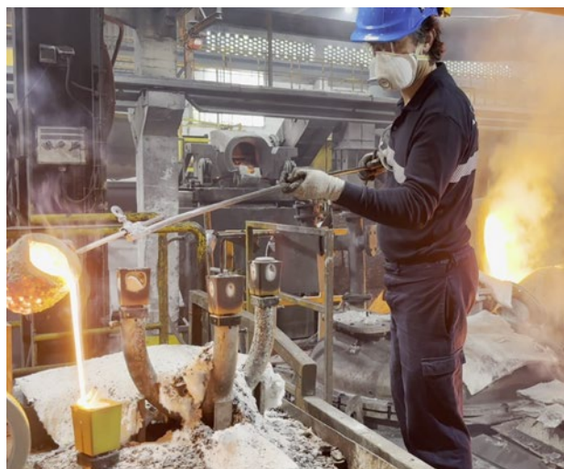
Figura 3. Aplicación típica de un sistema de análisis térmico en la plataforma fusora y visor de resultados in situ
