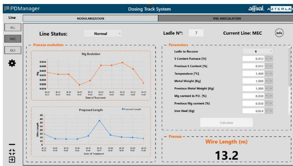
Figura 9. Cálculo de la cantidad de Mg a adicionar a partir de datos de tratamientos anteriores realizado con el sistema inteligente Dosing Track de AZTERLAN
