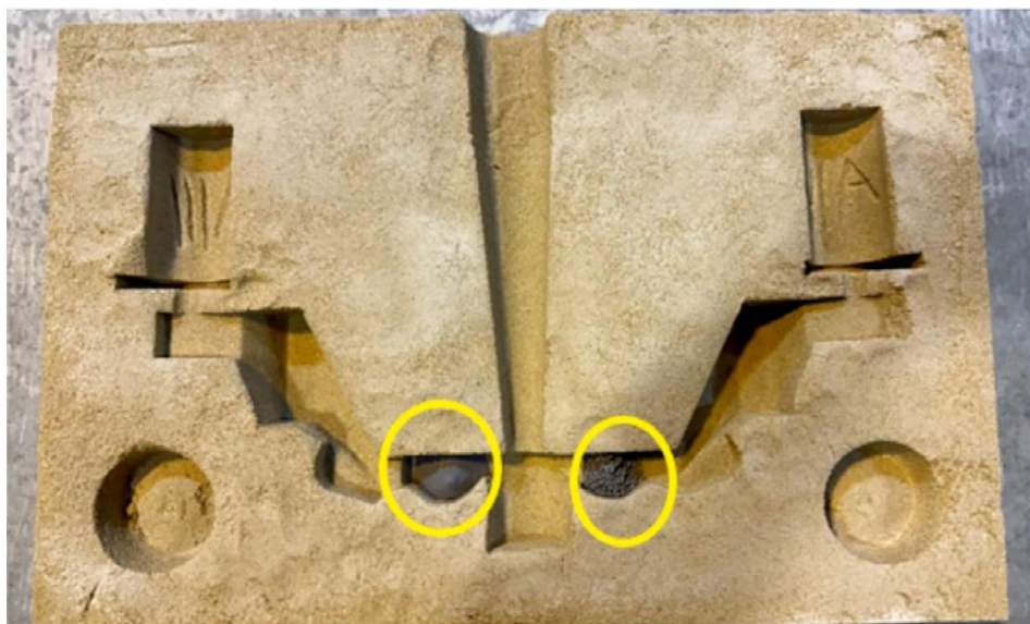
Figura 1. Molde empleado para las coladas experimentales con postinoculación in-mold . En amarillo se indican las cámaras de inoculación en la cavidad de moldeo
