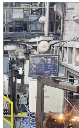
Figura 3. Aplicación típica de un sistema de análisis térmico en la plataforma fusora y visor de resultados in situ
